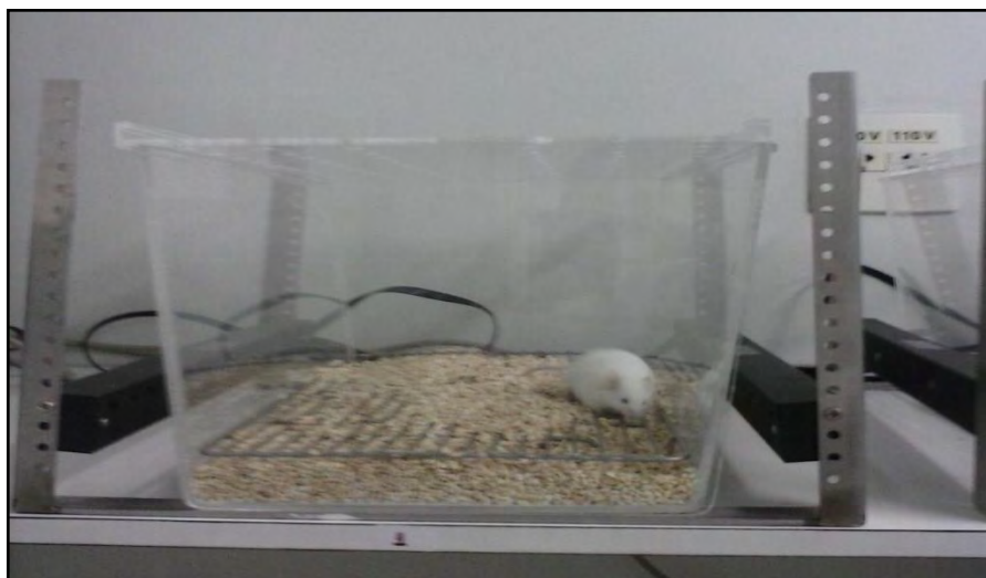
Figura 5. Caixa locomotora utilizada para o registro da atividade motora de camundongos. Foto: William Carvalho Amaral.
