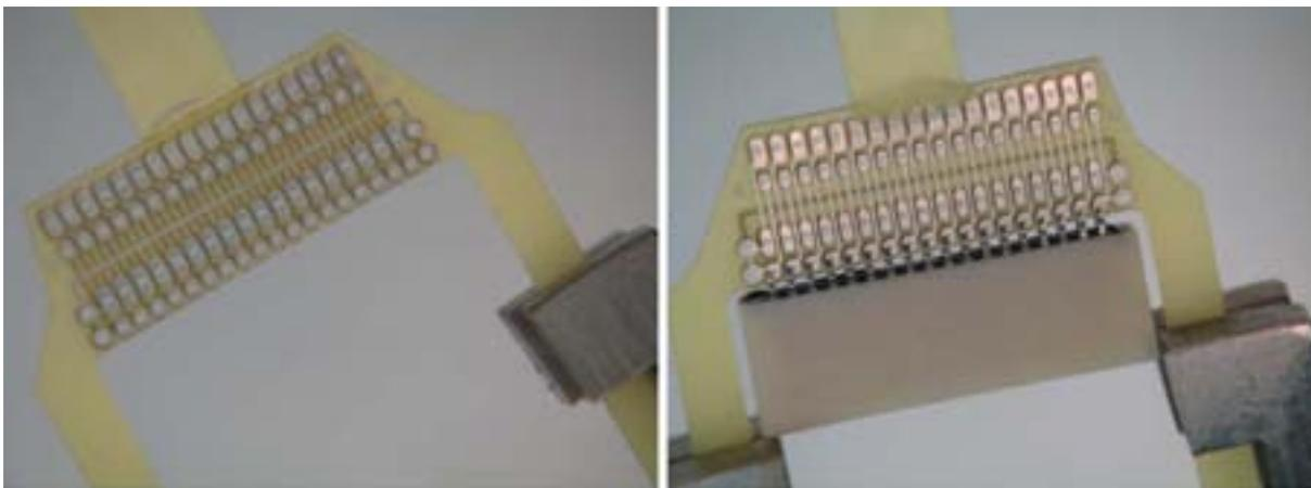
**Figura 10** - Placa de plástico perfurado com trilhas metálicas condutivas (esquerda) e micro conector Omnetics<sup>®</sup> já encaixado na placa (direita) para montagem de matrizes de eletrodos.
